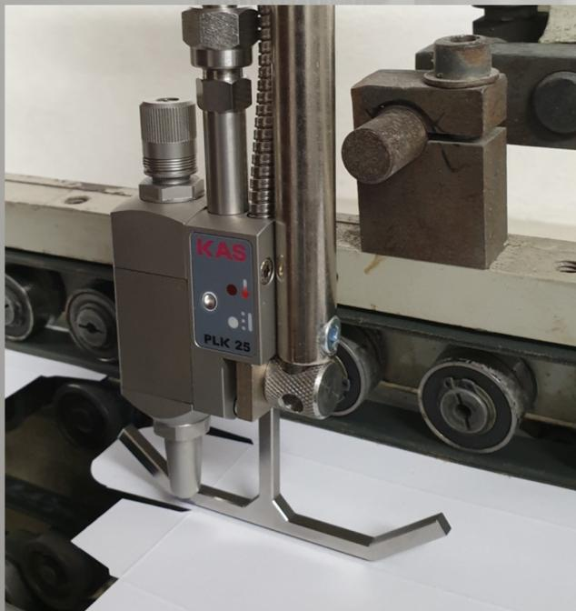
Dies Klebeventil Serie PLK25 ist die beste Wahl, wenn es um einen zielgenauen und sicheren Präzisionsauftrag bei hohen Geschwindigkeiten und schwierigen Auftragsbedingungen geht.
